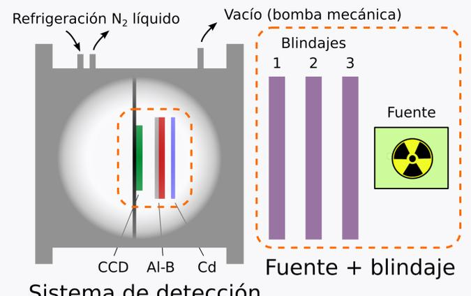
**Sistema detección:** CCD (2k x 2k, pixel  $15\mu\text{m}$ ) refrigerado con  $\text{LN}_2$  ubicado en un recinto al vacío que lo preserva de condensación de la humedad ambiente y permite el libre tránsito de  $\alpha$  emitidos por el  $^{10}\text{B}$  depositado en una
