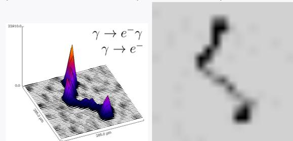
$\gamma$  de alta energía producen efecto foto-eléctrico o compton.
