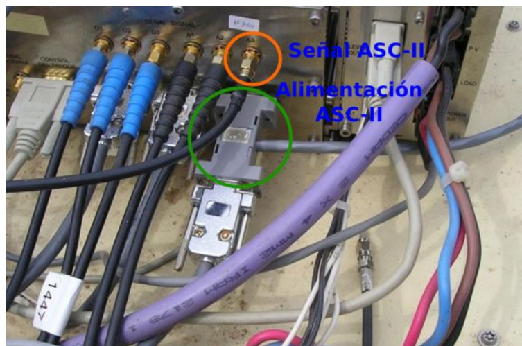
Figura 5.12: Fotografía de la conexión de ASC-II a la Local Station de Cuixart. Se observa que el ánodo del PMT 3 fue reemplazado por la señal de ASC-II y que una "T" deriva la alimentación de ASC-II del puerto de alimentación del PMT 3.
